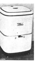
Machine, selon figure, pour laver et essorer le linge et pour laver la vaisselle. Entraînement par moteur monophasé ventilé à induit en court-circuit, avec enroulement auxiliaire, condensateur de démarrage et interrupteur centrifuge. Tambour à linge avec agitateur, interchangeable avec un dispositif à laver la vaisselle. Cordon de raccordement à trois conducteurs, fixé à la machine, avec fiche 2P+T.
