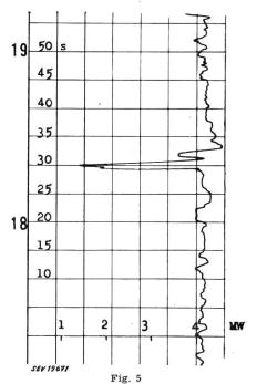
Contrôle au moyen d'un relais delta du réglage de la puissance active, aux bornes d'un convertisseur synchrone
