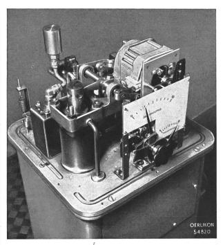
Fig. 3 Elektrohydraulischer Leistungsregler Verschalung teilweise entfernt
