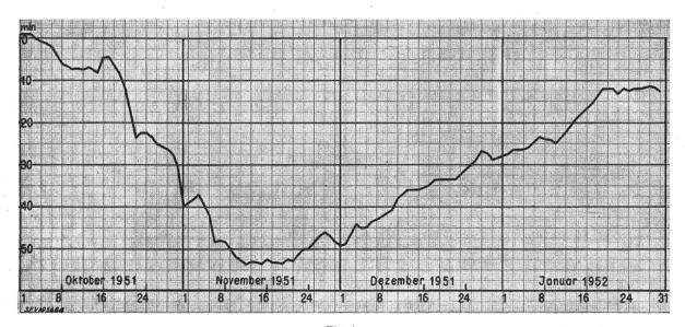
Fig. 1 Frequenzschwankungen im Drehstromnetz auf Grund der Gangkurve einer Synchronuhr
