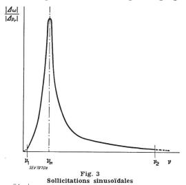
$\frac{|\Delta\omega|}{|\Delta\omega|}$  des amplitudes en fonction de la fréquence  $\nu$ Rapport  $|\Delta p_r|$ de la sollicitation  $u_1$  de l'ordre de quelques centièmes de Hz  $u_m$  de l'ordre de 0,05 à 0,10 Hz  $u_2$  de l'ordre du Hz
