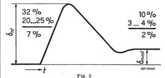
Prozentuale Drehzahländerung bei Abschaltung der Vollast t Zeit;  $\delta_{nt}$  vorübergehender relativer Drehzahlanstieg;  $\delta_{n}$   $_{voit}$  bleibende relative Drehzahländerung (Statik)
