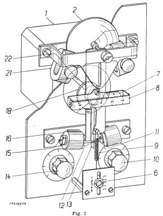
Aufbau des MFO-Blindleistungsreglers
