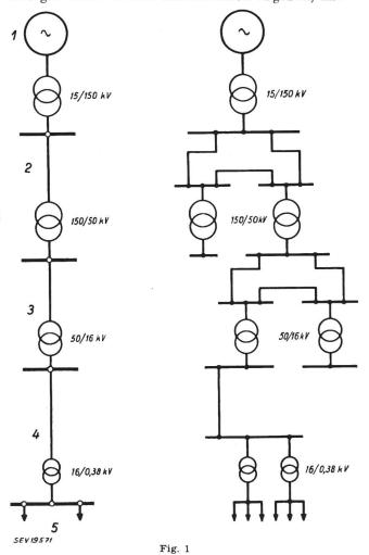
Schaltschemata von Energie-Übertragungssystemen 1 Stromerzeuger; 2 Hochspannungs-Übertragungsnetz; 3 Mittelspannungsnetz; 4 Hochspannungs-Verteilnetz; 5 Niederspannungs-Verteilnetz (Verbraucher)
