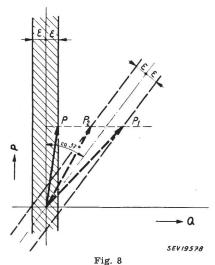
Wirkung des Blindleistungsreglers  $P, P_1, P_2$  Wirkleistung; Q Blindleistung;  $\xi$  Ansprechwert des Reglers
