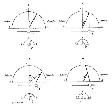
die Ordinate ist wieder die Wirkleistung P und auf die Abszisse die Blindleistung Q aufgetragen. Die Leistungsübertragung mit konstantem Leistungsfaktor zeigt Fig. 11a. Der Phasenwinkel  $\varphi$  ist rein äusserlich auch gegeben durch den Winkel zwischen
