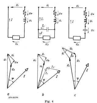
Vergleich der Wirkungsweise von Parallel- und Seriekondensatoren
