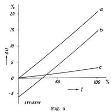
Spannungsabfall  $\Delta U$  in Funktion des Stromes I a ohne Kondensator; b mit Parallelkondensator; c mit Seriekondensator
