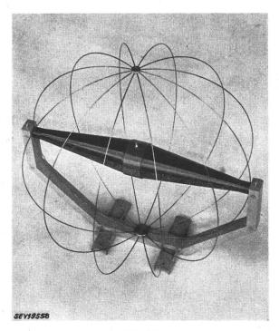
Fig. 17 Transformateur de tension sec, pôle—terre, 150 kV L'enveloppe sphérique indiquée limite l'espace électrique dans lequel ne doit se trouver aucun objet mis à la terre
