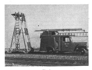
Fig. 2 Strassen- und Schienengängiger Hilfszug bereit für Schienenfahrt
