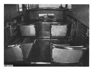
Fig. 4 Kastenraum des Hilfsfahrzeuges mit 4 Sitzen in abgeklappter Stellung
