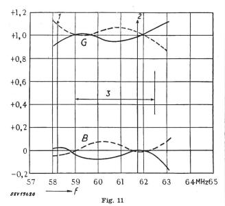
Verlauf des Eingangs-Scheinleitwertes der beiden Antennengruppen
