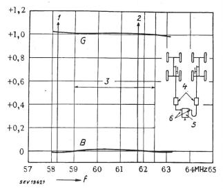
Fig. 12 Verlauf des Antennen-Scheinleitwertes am Ausgang des Diplexers
