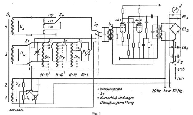
Prinzipschema für Windungszahl- und Kurzschlusswindungsmessung
