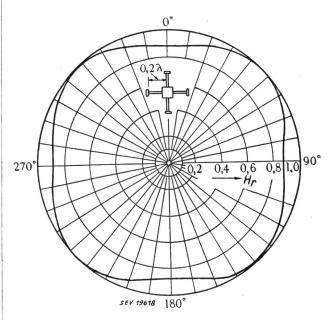
Fig. 9 Horizontales Richtdiagramm  $H_r$  relative Feldstärke
