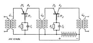
Fig. 7 Zweistufiger Transistor-Verstärker mit Transformatorkopplung Erklärungen siehe im Text
