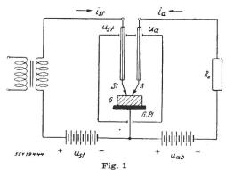
Schematische Darstellung von Aufbau und Verstärkerschaltung des A-Transistors Erklärungen siehe im Text
