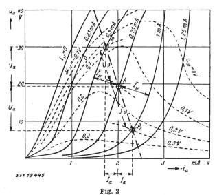
Statisches  $u_a$ - $i_a$ -Kennlinienfeld eines A-Transistors Erklärungen siehe im Text
