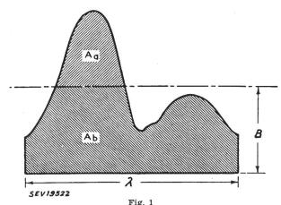
Lichtzeitkurve des Elektrodenflimmerns einer Fluoreszenzlampe reinweisser Lichtfarbe (standard coolwhite)
