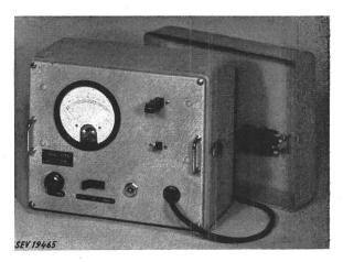
Fig. 1 «Norma»-Windungsschlussanzeiger
