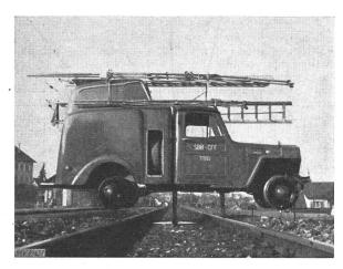
Fig. 3 Hilfsfahrzeug mit Schienenrädern in Wendestellung
