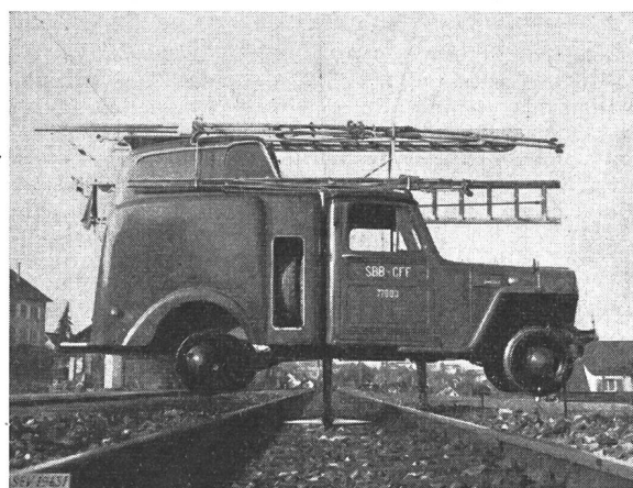
Fig. 3 Hilfsfahrzeug mit Schienenrädern in Wendestellung
