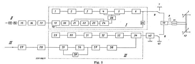
Blockschema des Bild- und Tonkanales
