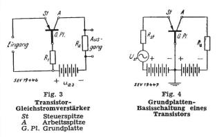
Fig. 3 zeigt einen einstufigen Gleichstromverstärker. Für Wechselstromverstärker sind, analog zur Triode, drei Grundschaltungen möglich. So entspricht z. B. die Grundplattenbasisschaltung von Fig. 4 der Gitterbasisschaltung der Triode usw. Tabelle I vermittelt einige Betriebswerte eines A-Transistors für die drei Grundschaltungen (vgl. Fig. 4, 5 und 6).
