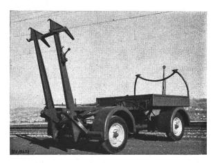
Fig. 5 Anhänger für Strassentransport von Rolleitern
