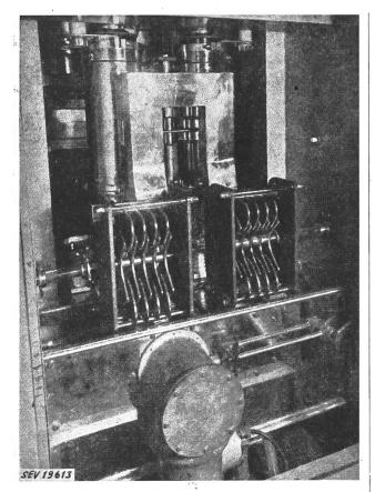
Fig. 4 Ansicht der End- und Auskoppelstufe des 45-kW-Bildsenders
