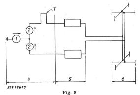
Schema der Antennenanlage 1 Ton; 2 Bild; 3 90°-Schleife; 4 Diplexer; 5 Symmetrierschleifen; 6 Antenne
