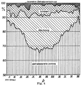
Anteil der betriebsbereiten Leistung an der installierten Kraftwerksleistung 1950
