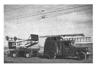
Fig. 1 Strassen- und Schienengängiger Hilfszug bereit für Strassenfahrt
