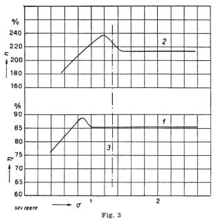
Einfluss des Kavitationsbeiwertes  $\sigma$  auf Durchgangsdrehzahl  $n_{max}$  (Kurve 2) und Turbinenwirkungsgrad  $\eta$  (Kurve 1) 3  $\sigma$  der Anlage
