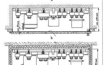
$\mathbf{c}$ Fig. 28 Exemple d'appareillage de distribution disposé de façon à ne pas pouvoir provoquer d'incendie Tiré des Prescriptions des FMB, deuxième édition, 1948, p. 35
