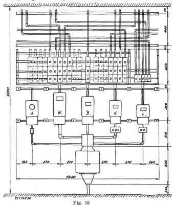
Schéma d'exécution de l'installation de la fig. 17
