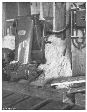
Fig. 33 Machine de scierie entraînée électriquement
