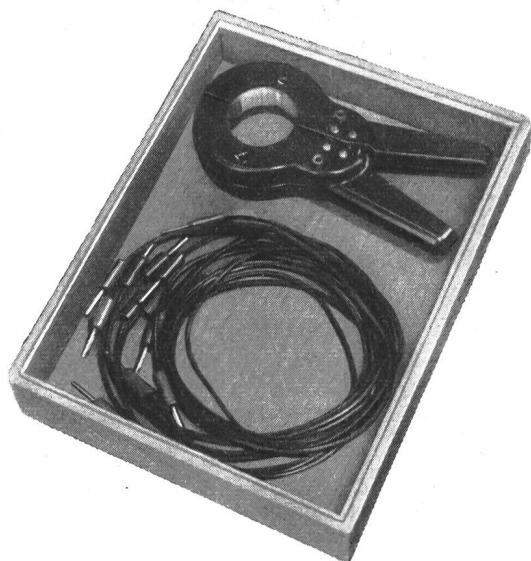
Fig. 3 Blindboden des Vancos-Meters für Zangenwandler und Anschlusskabel
