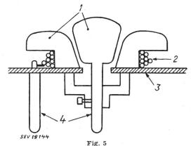
Niederspannungsfunkenstrecke der Electricité de France 1 Kupferelektroden; 2 8 Windungen; 3 Isolierplatte; 4 Anschlußstifte
