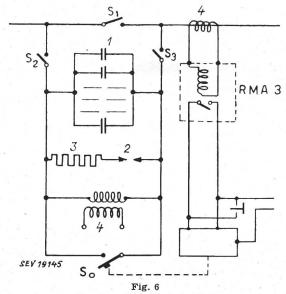
Niederspannungs-Kondensatorbatterie in der Leitung Azergues 1 Kondensatorbatterie; 2 Funkenstrecke; 3 Widerstand; Wandler;  $S_1...S_3$  Trennschalter;  $S_0$  automatischer Schutschalter; RMA 3 Relais automatischer Schutz-
