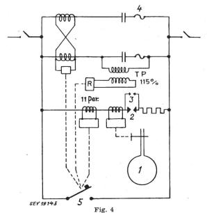
Schaltschema der Schutzeinrichtung der Kondensatorbatterie Chehalis
