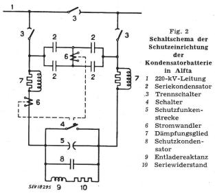
Entladungen zu vermeiden, werden in Serie der Schutzfunkenstrecke Widerstände (7) mit parallelgeschalteter Drosselspule eingebaut und zwar zwei pro Phase von 0,35  $\Omega$  bzw.  $150~\mu H,~d.~h.~0,047~\Omega$  bei 50 Hz und 1,4 $\Omega$  bei 1500 Hz.
