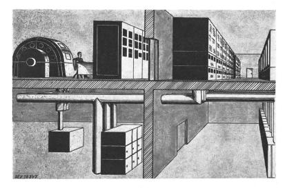
In neueren Kraftwerken wird die gesamte Leitungsführung von den Generatoren zur Schaltanlage und von dort zu den Transformatoren oder Leitungs-
