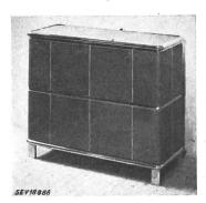
lation en briques superposées. Calorifugeage entre le noyau et la garniture de catelles. Commutateur de réglage monté sur le poêle. Presse-étoupe pour l'amenée de courant. Pieds en fer de 8 cm de hauteur. Longueur 870 mm, largeur 340 mm, hauteur 720 mm. Poids 280 kg.
