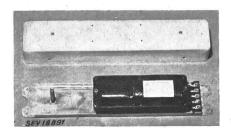
mateur pour tension primaire de 125, 145 et 220 V. Enroulements en fil de cuivre émaillé. Bornes sur socle en matière isolante moulée noire. Plaque de base et couvercle en tôle d'aluminium.
