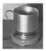
Petit réchaud, selon figure. Plaque en fonte de 85 mm de diamètre, sur socle en céramique. Régulateur de température dans le socle. Cordon de raccordement à deux conducteurs isolés au caoutchouc, fixé à l'appareil, avec fiche 2 P. Borne de mise à la terre. Récipient approprié en aluminium.
