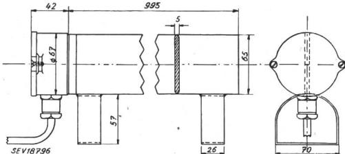
pour l'introduction de la ligne d'amenée de courant à trois conducteurs, fixée à l'appareil, avec fiche 2 P + T. Toutes les connexions sont soudées.
