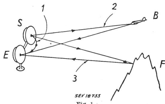
Von einem Radargerät empfangene Signale
