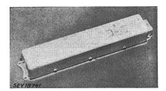
nelle. Condensateur en série, avec bobine de neutralisation basse fréquence. Condensateurs de déparasitage et d'allumage. Boîtier en tôle d'aluminium. Bobine de self-induction garnie de masse isolante. Bornes de raccordement à l'une des faces frontales, avec couvercle en tôle vissé. Borne de mise à la terre.
