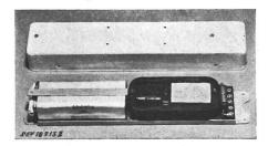
de chauffage. Condensateur de déparasitage de 0,04 µF en parallèle avec la lampe. Condensateur d'allumage de 0,0016 μF entre boîtier et réseau. Bornes sur socle en matière isolante moulée.
