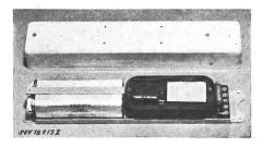
parallèle avec la lampe. Condensateur d'allumage de 0,0016  $\mu F$  entre boîtier et réseau. Bornes sur socle en matière isolante moulée.
