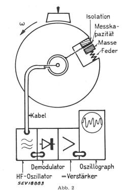
Prinzip des Winkelbeschleunigungsmessers Meßsystem hoher Eigenfrequenz, bestehend aus kleiner Masse und Hartfeder
