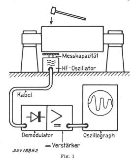
Kapazitiver Erschütterungsmesser Messung der durch Hammerschlag angestossenen Eigenschwingungen eines Rotors
