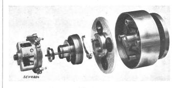
Fig. 3 Einzelteile des Winkelbeschleunigungsmessers Bürstenbrücke, Schleifring, Messkondensatorplatten auf starrer Platte und abgefedertem Schwungrad
