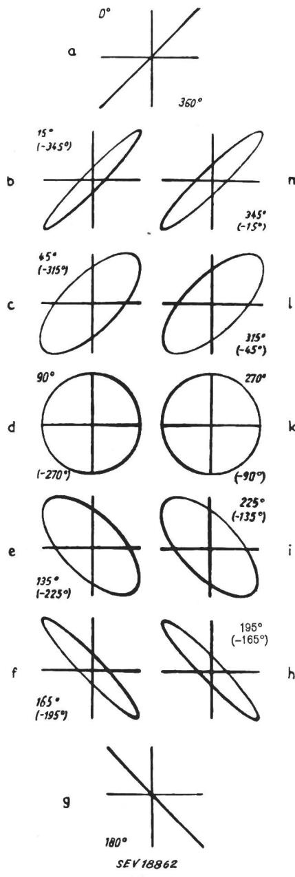
Oszillogramme zur Phasenmessung mit Hellsteuerung zur eindeutigen Kennzeichnung für alle Bilder zwischen  $0^\circ$  und  $360^\circ$
