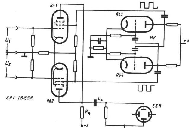
nen vielmehr nacheinander auf die zu beobachtenden Spannungen geschaltet werden. Wichtig ist dabei, dass man das Kippgerät immer mit der Bezugsspannung synchronisiert, wodurch sichergestellt wird, dass die Zeitablenkung synchron mit dieser läuft und die Bilder der übrigen Spannungen die Phasenlage getreu wiedergeben.
