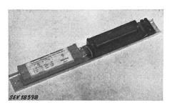
0,01 µF, en parallèle avec la lampe. Plaque de base en tôle d'aluminium. Bornes sur socle en matière isolante moulée. Appareil d'exécution étroite, sans couvercle, pour montage dans le luminaire.
