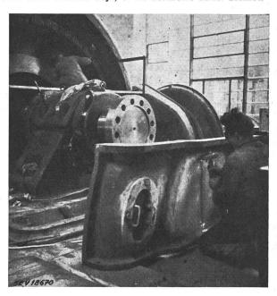
Fig. 3 Bâti d'une turbine Pelton, dont une fissure a été resoudé à l'électrode Castolin  $N^\circ$  24 Vue lors de l'usinage du cordon de soudure. Epaisseur de la fonte 30...35 mm
