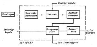
Fig. 3 Blockschaltbild des Phonevision-Entschlüsslers (Decoder)
