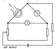
Fig. 2 Brückenschaltung für Vacuum-Messungen und Gas-Analysen
