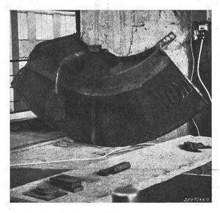
Culasse en fonte d'un alternateur de 30 000 kVA, fissurée sur une longueur d'environ 1 m et soudée à l'électrode Castolin N° 24 Epaisseur de la fonte environ 30 mm
