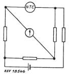
Fig. 1 Brückenschaltung mit NTC-Widerstand für **Temperaturmessung**
