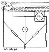
Fig. 3 Messung der Strömungsgeschwindigkeit von Flüssigkeiten und Gasen
