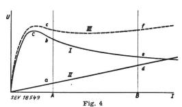
Strom-Spannungskurve eines NTC-Widerstandes (I), eines Ohmschen (II) und ihrer Kombination (III)
