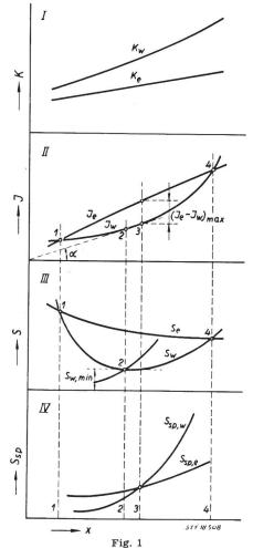
Vergleich der wirtschaftlichen Kennwerte von Kraftwerken K Anlagekosten; J Betriebsausgaben (Fr./Jahr); s mittlere Energiekosten (Fr./MWh);  $s_{sp}$  Kosten der zusätzlichen Energie (Fr./MWh); Index w Werte des untersuchten Wasserkraftwerkes; Index e Werte der Ersatzkraftwerke; x allgemeiner Parameter ( $P_n$ , W oder  $t_n$ )
