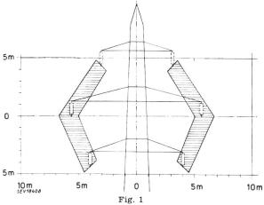
Querschnitt des durch die 150-kV-Cu-Leitungen beanspruchten Leiterraumes
