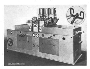
Fig. 15 Doppeltwirkende Abschmelzschweissmaschine, gespiesen durch ein 3-Phasen-Lastausgleichgerät
