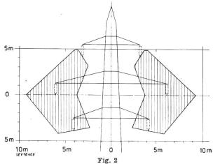
Querschnitt des durch die 150-kV-Leichtmetall-Leitungen beanspruchten Leiterraumes
