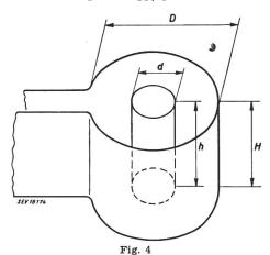
Arbeitsspule mit Arbeitsstück D, d Durchmesser; H, h Höhen
