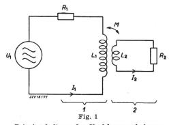
Prinzipschaltung der Hochfrequenzheizung  $U_1$  Spannung:  $I_1$ ,  $I_2$  Ströme;  $R_1$ ,  $R_2$  Widerstände;  $L_1$ ,  $L_2$  Induktivitäten; 1 Arbeitsspule; 2 Werkstück
