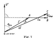
Vektordiagramm des Kabelringwandlers bei vorwiegend induktiver Belastung
