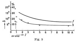
Fehlwinkel δ und Übersetzungsfehler f eines Kabelringwandlers in Abhängigkeit vom Erdschlußstrom I
