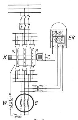
Fig. 11 Schaltung eines empfindlichen Generator-Gehäuseschluss-Schutzes
