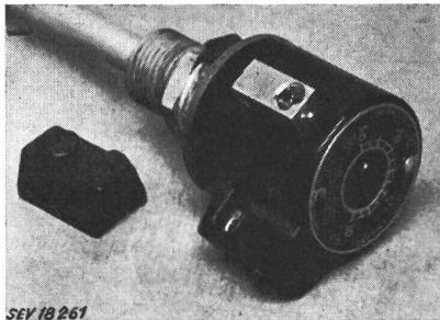
par bouton rotatif. Le coupe-circuit thermique à vis comporte une tige isolante soudée et soumise à l'action d'un ressort, qui maintient enclenchés les contacts en argent du dispositif de sûreté. Lorsque la température atteint une valeur déterminée, la soudure s'amollit, la tige isolante se déplace et les contacts du dispositif de sûreté se séparent.
