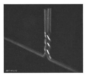
Fig. 1 Abgebogene und parallel gerichtete Rein-Aluminium-Drähte (28 mm² Querschnitt), bereit zum Ansetzen der Zange
