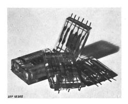
Fig. 4 In Markon-Harz eingebettete Kondensatoren und Widerstände
