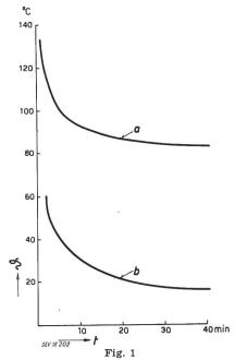
Härtungszeit t als Funktion der Temperatur  $\mathfrak S$  a mit 2 % Benzol-Peroxyd; b mit 2 % Katalysator HCH und 4 % Beschleuniger E
