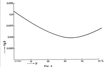
Der Einfluss eines erhöhten Styrol-Gehaltes V in der Harzmischung auf den Verlustwinkel tgδ
