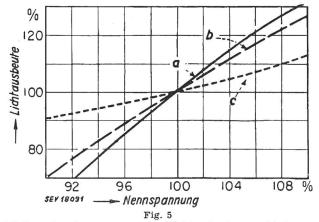
Einfluss der Spannung auf die Lichtausbeute verschiedener Lichtquellen a Glühlampe; b Quecksilberdampflampe; c Fluoreszenzlampe
