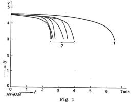
Kontinuierliche Entladung mit  $I=3,3 \times$  Kapazität bei  $-18\,^{\circ}$ C. I Im Artikel des Bulletins Nr. 2 des SEV, Seite 66, veröffentlichte Kurve für die Dynamic-Batterien.
