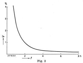
Einfluss des Beschleuniger-Anteils V auf die Härtungszeit t (mit 2 % Katalysator HCH)
