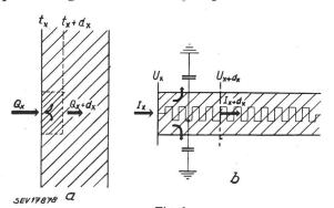
Fig. 1 Analogie zwischen der Aufheizung einer Wand a und der Aufladung eines Kabels b (nach W. Fischer)
