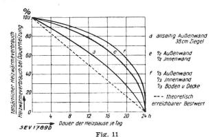
Mögliche Ersparnisse an Heizwärme bei unterbrochener Heizung gegenüber Dauerheizung bei 0 bis 24 h täglicher Heizpause
