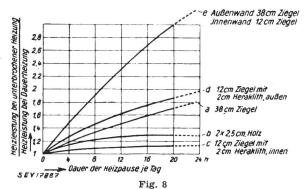
Erforderliche Erhöhung der Heizleistung bei unterbrochener Heizung gegenüber Dauerheizung bei 0 bis 24 h täglicher Heizpause
