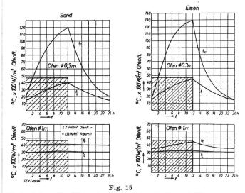
Verlauf der Oberflächentemperatur  $t_F$ , der Raumlufttemperatur  $t_L$  und der erforderlichen Heizleistungen bei der Beheizung eines Raumes mit Speicheröfen verschiedenen Speichervermögens
