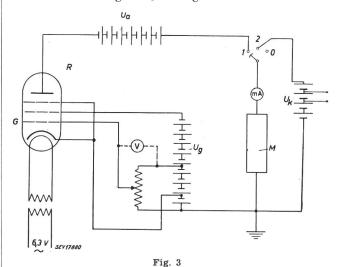
Schaltbild der röhrengesteuerten Einrichtung zur Konstanthaltung von Modellströmen und Modellspannungen R Pentode mit hohem Innenwiderstand; G Steuergitter; M Modell;  $U_a$  Anodenspannung;  $U_{\theta}$  Gitterspannung;  $U_k$  konstante Spannungsquelle mit verschiedenen Anzapfungen
