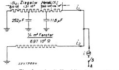
c Ziegelwand mit Heraklith-Innenauskleidung
