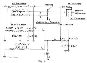
Bauliche Anordnung und Modellbild für den Fall e Temperatur der inneren Oberfläche der Aussenwand entsprechend der Spannung  $U_1$
