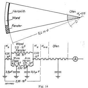
Abbildungsweise eines Speicherofens, der zur Beheizung eines innen mit Heraklith ausgekleideten Raumes dient Zylindrische Darstellung
