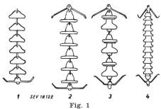
Entwicklung der Freileitungs-Hängeisolatoren 1 Hewlett-Isolator; 2 Kappenisolator; 3 Vollkernisolator; 4 Motor-Langstabisolator Der Metallanteil verglichen mit dem Totalgewicht des Isolators ist bei Kappenisolatoren 49 %, bei Motorisolatoren 35,5 %,
