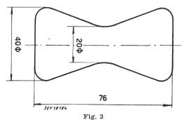
Porzellan-Prüfkörper zur Bestimmung der Zugfestigkeit
