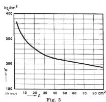
Mittlere Zugfestigkeit  $\sigma$  eines bestimmten glasierten Hartporzellans in Abhängigkeit vom Querschnitt A
