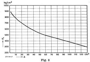
Mittlere Biegefestigkeit  $K_s$  eines bestimmten glasierten Hartporzellans in Abhängigkeit vom Querschnitt A
