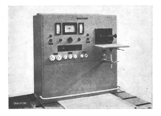
Fig. 10 10-kW-Mittelfrequenz-Hartlötanlage für 12 kHz (System MFO)
