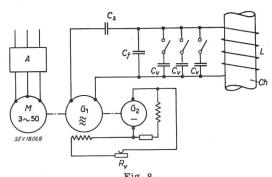
Prinzipschema des Mittelfrequenz-Umformers
