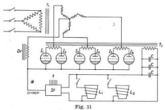
Prinzipschema des Quecksilberdampf-Umformers  $T_1$  Eingangs-Transformator;  $T_2$  Ausgangstransformator; Dr Drosselspule;  $I_1...I_6$  Ignitron-Röhren;  $L_1$ ,  $L_2$  Heizspulen; C Parallelkondensator; St Steuergerät; I zu den Gittern
