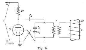
Prinzipschema eines Röhrengenerators für induktive HF-Heizung
