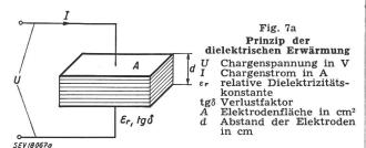
Fig. 7a zeigt die prinzipielle Anordnung für die kapazitive Heizung. Das äquivalente Ersatzschaltbild mit dem zugehörigen Vektordiagramm ist aus Fig. 7b ersichtlich. Aus der Fig. kann man direkt die folgenden Beziehungen ablesen:
