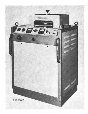
Fig. 17 2-kW-HF-Röhrengenerator für dielektrische Vorwärmung von Preßstoff
