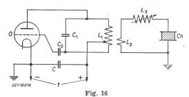
Prinzipschema eines HF-Röhrengenerators für dielektrische Heizung
