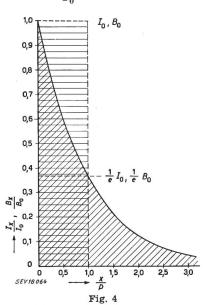
Strom- und Induktionsverteilung in einem Metallzylinder bei Hochfrequenz
