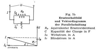
Der Winkel  $\delta$ , der den Phasenwinkel  $\varphi$  zu 90° ergänzt, heisst *Verlustwinkel*. Er ist für die in der Praxis vorkommenden Stoffe so klein, dass wir ohne grossen Fehler schreiben können:
