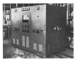
Fig. 15 Röhrengenerator für induktive Heizung HF-Ausgangsleistung 30 kW. Frequenz ca. 450 kHz (System Elcalor)
