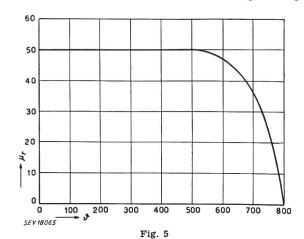
Verlauf der relativen Permeabilität in Abhängigkeit von der Temperatur für einen C-Stahl (nach Stansel)
