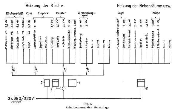
${\it 1}$  Schaltuhr des Versammlungslokals;  ${\it 2}$  Schaltuhr der Kirche;  ${\it I}$  Energiezähler der Kirchenheizung;  ${\it II}$  Energiezähler der Heizung von Nebenräumen usw.
