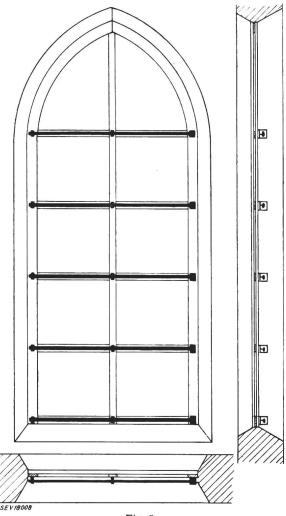
Fig. 3 Heizrohre an den Fenstersprossen System Oskar Locher, Zürich
