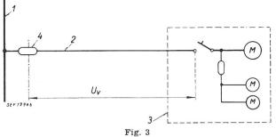
Kurzschlußsicherung eines nichtüberlastbaren Verbrauchers und der Anschlussleitung
