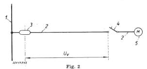
Kurzschlußsicherung eines überlastbaren Verbrauchers und der Anschlussleitung
