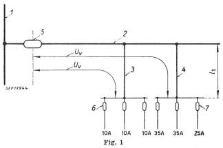
Leitungsschutz durch vorgeschalteten Kurzschlußschutz und nachgeschalteten Überlastungsschutz
