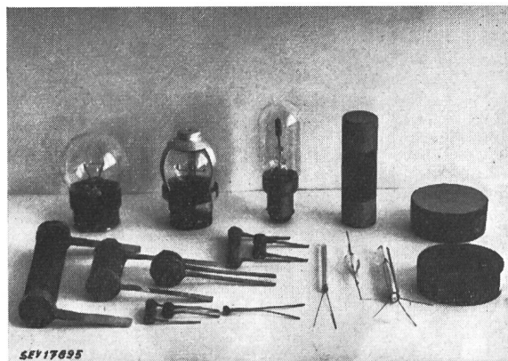
Fig. 1 Thermistors de différents types, du plus petit au plus grand modèle
