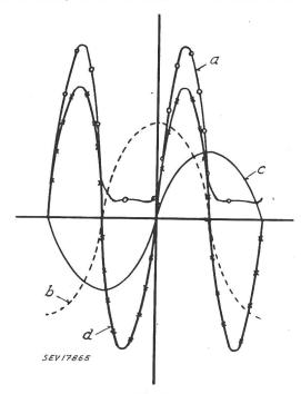
Phasenabhängigkeit der Lichtemission von der Spannung, dem Strom und der Leistung
