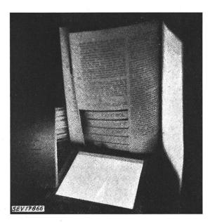
Fig. 3 Beispiel der Anwendung eines Leuchtkondensators
