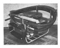
le dispositif de commande sont montés dans un berceau à poignées isolantes. Le dispositif de commande et, par conséquent, la tête vibrante sont isolés des parties susceptibles d'être sous tension en cas de défaut d'isolement. Interrupteur à tirette. Cordon de raccordement à quatre conducteurs, fixé au moteur, avec dispositif d'enroulement. Poid total du dispositif 80 kg environ.
