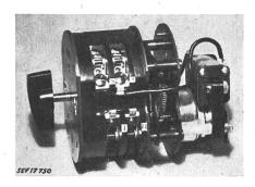
avec touches de contact en argent. En tournant la poignée à droite, l'interrupteur est enclenché et le moteur mis en marche. Ces interrupteurs horaires sont livrables pour des durées de marche maxima de 10 minutes à 24 heures. Ils possèdent une vis de mise à la terre.
