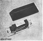
Appareil auxiliaire pour lampe fluorescente, selon figure, sans coupe-circuit thermique, ni starter. Enroulement en fil de cuivre émaillé. Plaque de base en tôle d'aluminium, couvercle en matière isolante moulée. Bornes sur support en matière isolante moulée, disposées à l'une des extrémités du noyau en fer.
