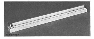
Luminaire pour lampe fluorescente à éclairage direct, destiné à des locaux présentant des dangers d'explosion. La lampe tubulaire est protégée contre les déprédations par un manchon en plexiglas; elle est également assurée contre tout dégagement intempestif. L'appareil auxiliaire et le thermostarter sont logés dans le carter en tôle et garnis de masse compound. Toutes les connexions sont soudées. Utilisation: dans les locaux présentant des dangers d'explosion.
