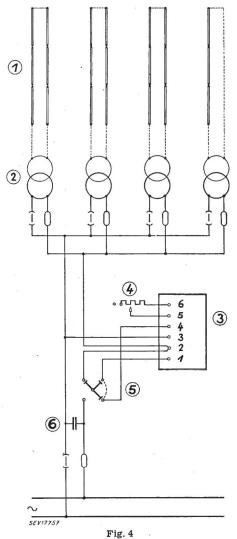
Kinosaal-Beleuchtung mit Hochspannungs-Fluoreszenzröhren und elektrischem Licht-Reguliergerät
