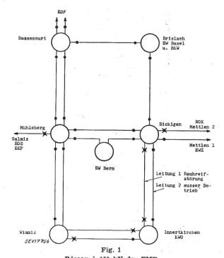
Réseau à 150 kV des FMB Perturbation due au grivage, le 26 octobre 1950, à 09 h 55
