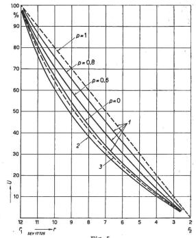
Fig. 5 Répartition de la tension, mesurée et calculée avec différents modes de charge, pour le câble de la iig. 4
