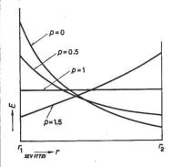
Fig. 3 Allure du gradient de tension dans l'isolant d'un câble pour d'fférents modes de charge Courbes pour  $0 \le p < 1$ : gradient de tension continue à vide ou de tension alternative à vide et en charge
