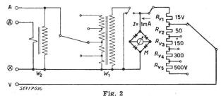
Spannungsmessung mit umschaltbaren Vorwiderständen M Drehspulmesswerk mit Gleichrichter
