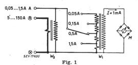
Strommessung. Grosser Messbereichumfang durch zwei hintereinander geschaltete Stromwandler M Drehspulmesswerk mit Gleichrichter  $W_1$ ,  $W_2$  Stromwandler A (A) (A) Klemmen
