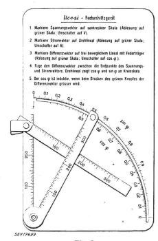
Fig. 5 Rechenhilfsmittel zur Ermittlung des  $\cos \varphi$  und des  $\sin \varphi$
