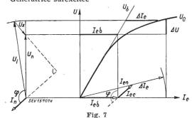
Détermination de la variation de tension et du courant d'excitation de la machine synchrone  $U_{\partial}$  tangente à l'origine de la caractéristique à vide;  $U_{\sigma}$  caractéristique à vide;  $U_{\sigma}$  tension de Potier;  $I_{\sigma\sigma}$  courant d'excitation en court-circuit à courant nominal;  $I_{\sigma\sigma}$  courant d'excitation en courant cation en service nominal
