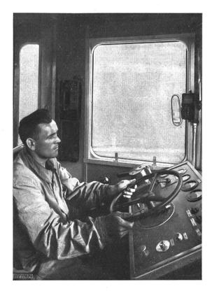
Fig. 1 Hochfrequenz-Telephonapparat im Führerstand des Triebwagens
