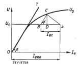
Fig. 6 Détermination de la tension de Potier de la machine synchrone Potter de la machine synchrone U tension aux bornes;  $U_0$  caractéristique à vide;  $I_e$  courant d'excitation;  $I_{en0}$  courant d'excitation pour  $U_n$ ,  $I_n$  et  $\cos \varphi = 0$ ;  $I_{eo}$  courant d'excitation en court-circuit pour le courant nominal;  $BC \parallel OT$ ;  $CD = U_X$  tension de Potier;  $\triangle ACD$  triangle de Potier
