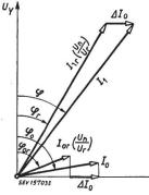
Fig. 3 Diagramme vectoriel de la machine à induction pour la détermination du vecteur du courant I
