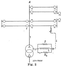
Einpoliges Prinzipschema der Erdschluss-Richtungsanzeige für ein vermaschtes Netz
