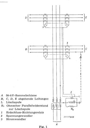
Prinzipschema einer Erdschluss-Richtungsanzeige in einem Strahlen-Netz
