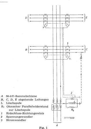
Prinzipschema einer Erdschluss-Richtungsanzeige in einem Strahlen-Netz
