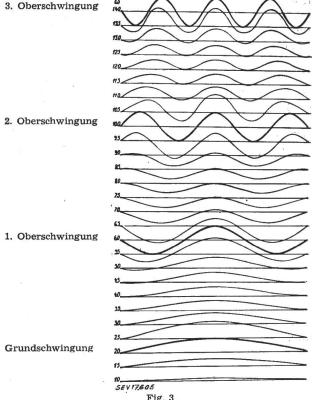
Ideelle Erregung eines Hohlseiles durch Windkräfte
