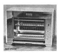
barreaux métalliques. Broche rotative commandée par un moteur monophasé autodémarreur à induit en court-circuit. Deux interrupteurs pour les éléments chauffants et le moteur, disposés sur le devant du gril. Cordon de raccordement à quatre conducteurs, sous double gaine isolante (3 P + T), fixé à l'appareil. Poignées en matière isolante.
