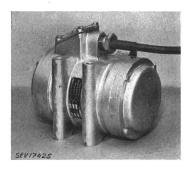
d'arbre tournent à l'intérieur de la carcasse et produisent les vibrations. Enroulement imprégné en fil de cuivre émaillé. Cordon de raccordement renforcé, de 2 m de longueur, fixé au moteur. Poids 18,5 kg.
