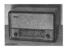
permanent. Transformateur de réseau à enroulements séparés. Enroulement primaire commutable, avec résistance en série. Protection contre les surcharges dans le circuit secondaire par petit fusible. Ecran relié au châssis entre les enroulements primaire et secondaire. Cordon de raccordement rond fixé à l'appareil, avec fiche. Boîtier en bois, fermé à l'arrière par une plaque de presspahn.
