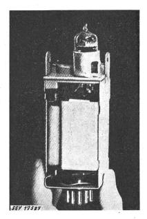
Fig. 7 Neuer Telephonverstärker der Bell Telephone mit Miniaturröhren
