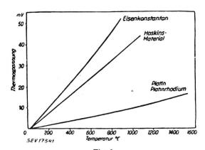
Verlauf der thermoelektrischen Spannung in Funktion der Temperatur für drei verschiedene Thermoelemente
