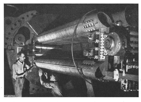
Fig. 10 Elektrostatischer Beschleuniger der General Electric für das Brookhaven National Laboratorium
