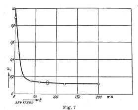
Geschwindigkeit der Ausbildung der a-Adaptation Abszisse: Zeit t in ms; Ordinate: Verhältnis e der Lichtintensität, die ohne Blendung  $(E_1)$  eine binoculare Gleichung ergibt, zu der Intensität, die mit der Blendung  $(E_2)$  diese Gleichung gibt  $\left(e = \frac{E_1}{E_2}\right)$
