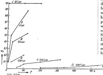
Fig. 12 Verlauf der Sehanpassung bei plötzlicher Herabsetzung der Beleuchtung (Koordinaten wie in Fig. 11)
