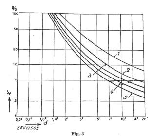
Physikalischer Kontrast  $\kappa$  des Prüfobjektes zum Hintergrund (bei verschiedenem Winkelabstand der blendenden Lichtquelle vom Fixierpunkt des Beobachers) in Funktion der Winkelgrösse  $\delta$  des Objektes
