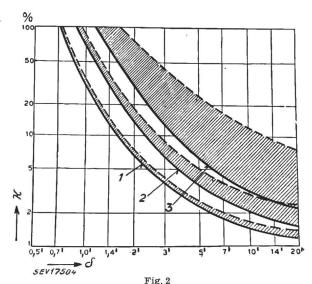
Physikalischer Kontrast  $\kappa$  des Prüfobjektes zum Hintergrund (bei drei verschiedenen Beleuchtungsstärken) in Funktion der Winkelgrösse  $\delta$  des Objektes
