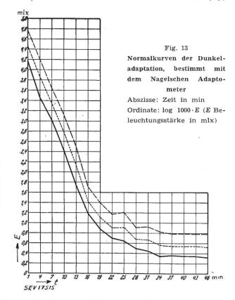
wann der Ring gesehen wird, ohne dass die Lage der Ringöffnung erkannt wird (R) und wann die Öffnung des Hakens dreimal richtig erkannt wird (I, II, III). Die drei Kurvenscharen zeigen, dass die Dunkeladaptation mit dem Alter schlechter wird.
