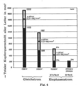
Vergleich der Totalquerschnitte der Übertragungs- und Fahrleitungen einer Doppelspur-Vollbahnstrecke für verschiedene Stromsysteme
