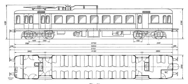
Typenbild des 1150-kW-Motorwagens der SNCF für Vorortsbetrieb, für Einphasenstrom 50 Hz, 20 kV
