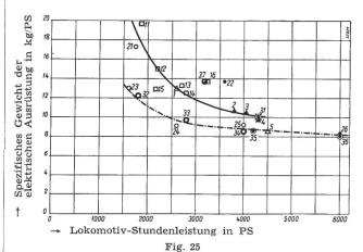
Vergleich der Gewichte der elektrischen Ausrüstungen der modernsten in Betrieb gesetzten und im Bau befindlichen laufachslosen Drehgestell-Lokomotiven für verschiedene Stromsysteme
