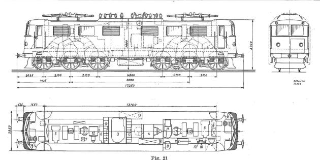
Typenbild der CoCo-Lokomotive der SNCF, 3160 kW, für Einphasenstrom 50 Hz, 20 kV
