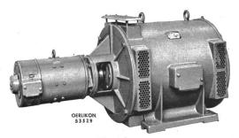
Fig. 18 Arno-Umformer 110 kVA der SNCF-Lokomotive CoCo für Einphasenstrom 50 Hz, mit Gleichstrom-Nebenschlussgenerator für Batterieladung
