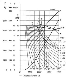
Fig. 7 Charakteristik der Triebmotoren SNCF der CoCo-Lokomotive der
