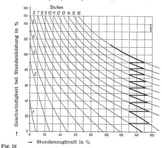
Vergleich der Abstufungen für Einphasenstrom 16% und 50 Hz
