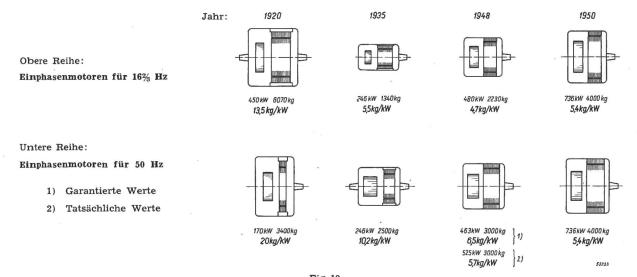
Fig. 10 Vergleich der Entwicklung von Einphasen-Triebmotoren für 16% und 50 Hz im Zeitraum von 1920...1950
