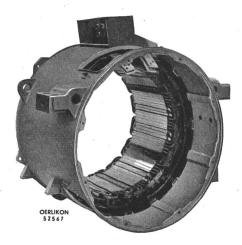
Der Motor besitzt nicht mehr Kohlenbürsten als Motoren ungefähr gleicher Leistung für 162/3 Hz, wie sie noch vor 20...15 Jahren in grossen Serien für die Schweizerischen Bundesbahnen gebaut wurden und zu den besten Triebmotoren gezählt werden. Insbesondere wurde die Kohlenzahl für den Unterhalt nicht störend empfunden, und die Kollektoren erreichen laufend Laufleistungen von über
