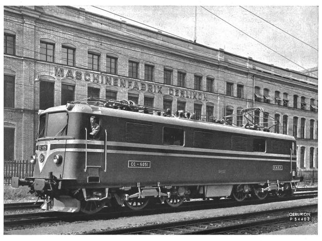
Fig. 2 Die CoCo-Lokomotive von 3160 kW für Einphasenstrom 50 Hz, der Société Nationale des Chemins de Fer Français
