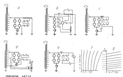
tung, nach Schema b und c in Fig. 17. Zufolge der höheren Frequenz werden die Dimensionen der Bremsdrosselspulen wesentlich kleiner als bei 16<sup>2</sup>/<sub>3</sub> Hz.
