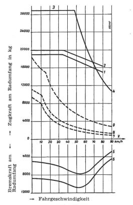
Fig. 22 Fahr- und Bremscharakteristiken der Lokomotive Einphasenstrom 50 Hz, 20 kV: Gleichstrom 1500 V:
