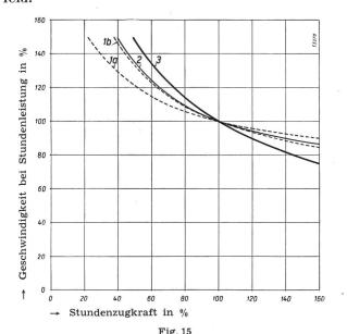
Vergleich der Charakteristiken von Triebmotoren für verschiedene Stromsysteme
