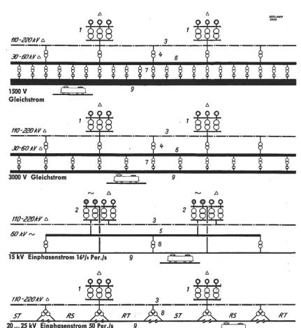
Bei der Elektrifikation mit Gleichstrom wird normalerweise längs der Bahn eine Zwischen-Übertragungsleitung von 30...60 kV,  $2\times3$  Leiter, erstellt.
