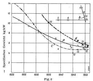
Entwicklung des Verhältnisses Gewicht zu Leistung der Triebmotoren in den Jahren 1920...1950
