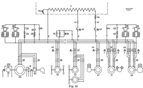
Schema der Hilfsbetriebe einer grösseren Lokomotive für Einphasens Hilfsbetriebe-Motoren Einphasenstrom 50 Hz, mit Arno-Umformer und Drehstrom-
