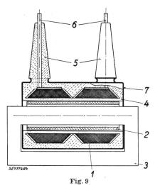
Esquisse de principe d'un transformateur de tension à résine synthétique, bipolaire, avec 2 bobines en couches guidées
