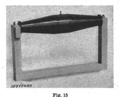
Transformateur de tension à résine synthétique 60 kV, avec couches guidées, un pôle et le noyau mis à la terre
