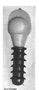
la tension d'essai peuvent être augmentées d'une manière importante. Par exemple, un de ces transformateurs est représenté à la figure 3, pour une tension nominale de 10 kV, une intensité primaire de 200 A et une puissance de 10 VA en classe 0,5. Les dimensions du bloc cylindrique se montent à: 100 mm de diamètre et 120 mm en direction de la barre collectrice. Un transformateur de courant semblable pour 500 A, 20 VA classe 0,5 a comme dimensions correspondantes 100 imes70 mm.
