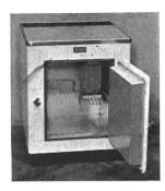
Réfrigérateur, selon figure. Groupe réfrigérant à absorption fonctionnant en permanence, à refroidissement naturel par air. Evaporateur avec tiroir à glace disposé latéralement, en haut de l'enceinte. Cuiseur logé dans un carter en tôle. Cordon de raccordement rond à trois conducteur, fixé, avec fiche 2 P + T. Dimensions: enceinte 420  $\times$  360  $\times$  300 mm; réfrigérateur 685  $\times$  570  $\times$  570 mm. Contenance utile 40 dm³. Poids 51 kg.
