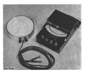
Luxmeter mit diffundierender, farbkorrigierter Mehrzellen-Platte
