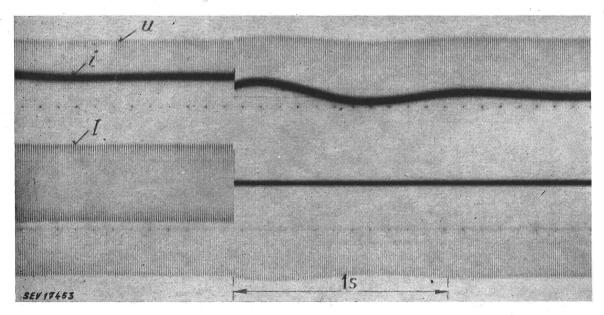
Fig. 8 Relevé du comportement du générateur à la suite d'une brusque variation de la charge
