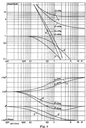
Courbes d'allure du réglage à tension constante d'un générateur synchrone, sous forme cartésienne
