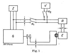
Schéma de principe d'un réglage de tension
