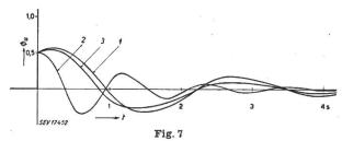
Courbe de réponse du réglage fermé décrivant les variations de la tension aux bornes du générateur à la suite d'une augmen-tation brusque de sa charge
